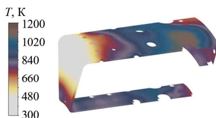
Рис. 4. Распределение цветов побежалости на поверхности жаровой трубы для камеры сгорания двигателя JetCat P100-RX (полный расход керосина)
