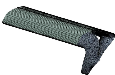
Рис. 3. Сеточная модель одного сегмента статора
