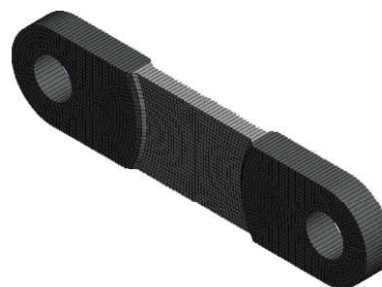
Рис. 4. Конечно-элементная модель конструктивно-подобного элемента «серьга»
