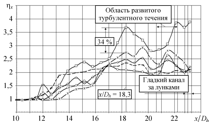
Рис. 7. Сравнение локальной теплоэнергетической характеристики различных модификаций лунок и полусферических выпуклостей при Re_d = 40000 (модель S–A)
